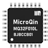
杭州微秦科技的MQ32FOX0系列，内嵌低功耗32位CPU核，从客户需求出发，以电机控制的创新技术来定义的电机控制MCU芯片。该系列满足电机客户在各种高中低性能应用场景下性能及高性价比需求，从而降低技术研发门槛，并大大缩短新产品的开发周期。该系列简单灵活，使用友好，能大大降低客户的研发和管理成本。芯片内部集成了微秦领先业界的无感FOC单元 ( sensorless FOC )、运算放大器、比较器、高速乘法/除法器、12位高速多通道ADC、SPI & UART & I2C通讯、高级定时器等功能，可以为绝大多数电机控制应用场景提供系统级的解决方案。
